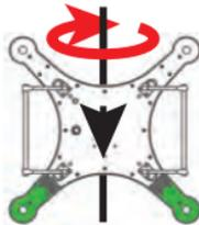
8. Sostenga el **drone boca abajo**, luego gire el dron a su alrededor en el **sentido de las agujas del reloj** una rotación completa (360 grados).
