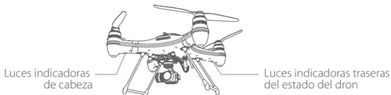
Las luces LED indicadoras de la cabeza están siempre encendidas y se utilizan para indicar la dirección de la cabeza del dron. Las luces de estado de la aeronave trasera indican el estado actual del sistema de control de vuelo por los patrones parpadeantes de luces de referencia, verde y amarillo. Consulte la siguiente tabla para ver los diferentes mensajes
