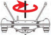
5. Gire el dron **boca abajo**, luego gire el dron a su alrededor en el **sentido de las agujas del reloj** una rotación completa (360 grados).
